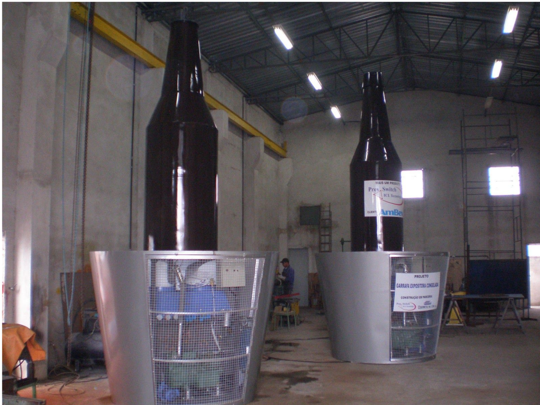
Fig. 1 - A Unidade Condensadora na base da Garrafa
